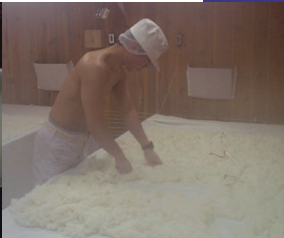
⑤蒸した米に黄麹菌を繁殖させる麹室。厳寒の酒造場でここだけが温かい。(東光醸造元・山形県米沢市)
