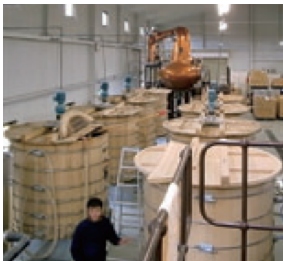
発酵槽はどれもミズナラ製。蒸溜器はスコットランドのメーカーに特注したもの
