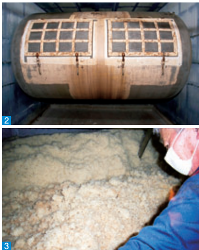
1 蒸溜酒を食事中に飲むのはアジアの文化。日本では割っておいしい焼酎が求められた 2 一次仕込みで使う米麴をつくるドラム式製麴装置 3 ドラムのなかには米がたくさん 4 今も昔ながらに甕で仕込む蔵も少なくない
