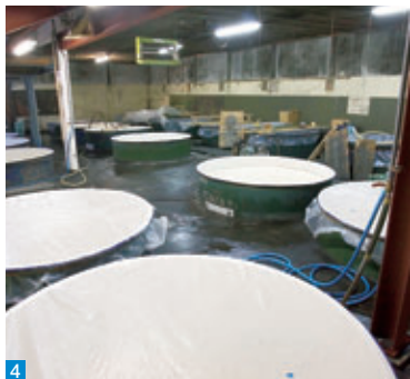
1 蒸溜酒を食事中に飲むのはアジアの文化。日本では割っておいしい焼酎が求められた 2 一次仕込みで使う米麴をつくるドラム式製麴装置 3 ドラムのなかには米がたくさん 4 今も昔ながらに甕で仕込む蔵も少なくない
