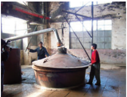
これが蒸溜器。蒸溜は次の仕込みの雑穀の蒸しを兼ねる
