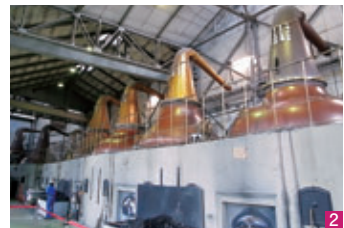
1 2 余市蒸溜所は力強いモルト原酒を生み出す蒸溜釜を直火で加熱する
