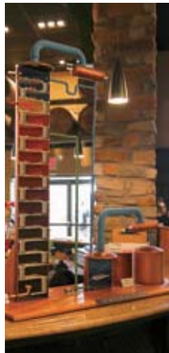
バーボンは連続式蒸溜機を使う。内部を示した模型
